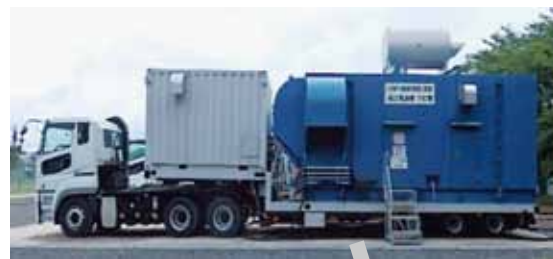
高圧電源装置
