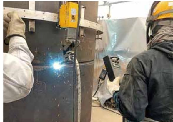
ロボットでの溶接の様子(図4)
