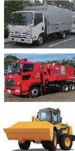
可搬型設備（電源車、ポンプ車、ホイールローダ等）
