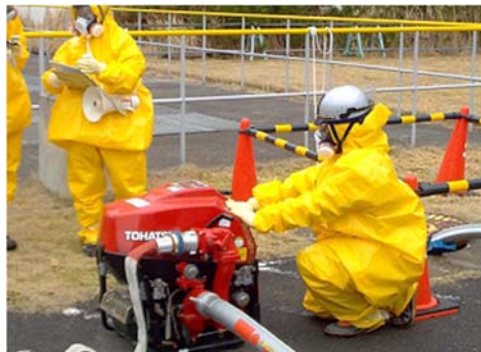
水源確保訓練：防火水槽から可搬式設備を用いた注水作業の確認
