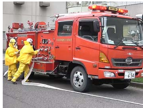
水源確保訓練：防火水槽から可搬式設備を用いた注水作業の確認
