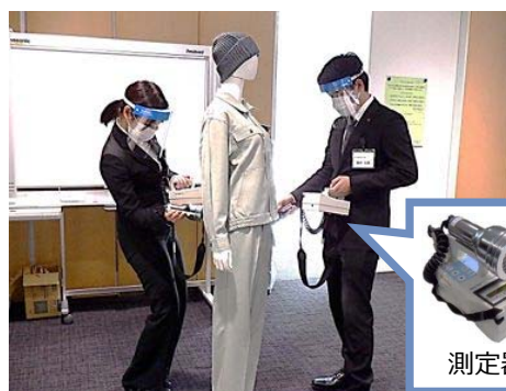
放射線管理の基礎 (測定器での体表面放射性物質付着の確認)
