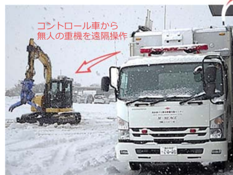
コントロール車からの無人の重機を遠隔操作 コントロール車内のモニター操作による重機の無線制御技術の視察 (美浜原子力緊急事態支援センター)
