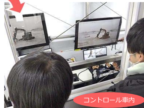
コントロール車からの無人の重機を遠隔操作 コントロール車内のモニター操作による重機の無線制御技術の視察 (美浜原子力緊急事態支援センター)
