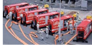
大容量ポンプ(6台)
