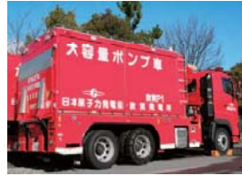
大容量ポンプ車(2台)
