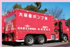
大容量ポンプ車
