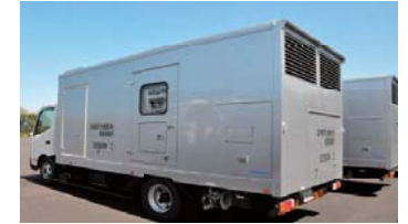
低圧電源車(4台)
