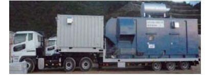
高圧電源車 1,825kVA (4台)
