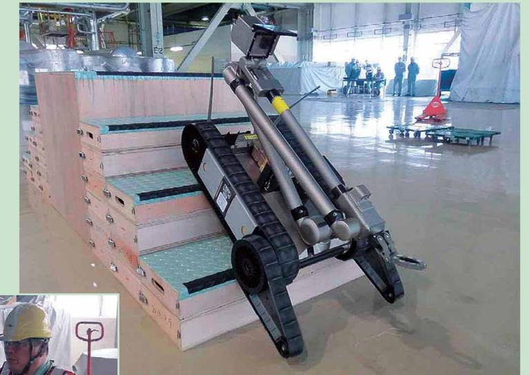
災害現場を探索するための災害対策用ロボットの遠隔操作訓練
