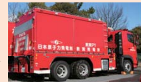
可搬型代替注水中型ポンプ
