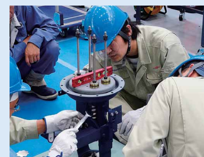
手順に従って分解・点検（各部品の構造等も確認）
