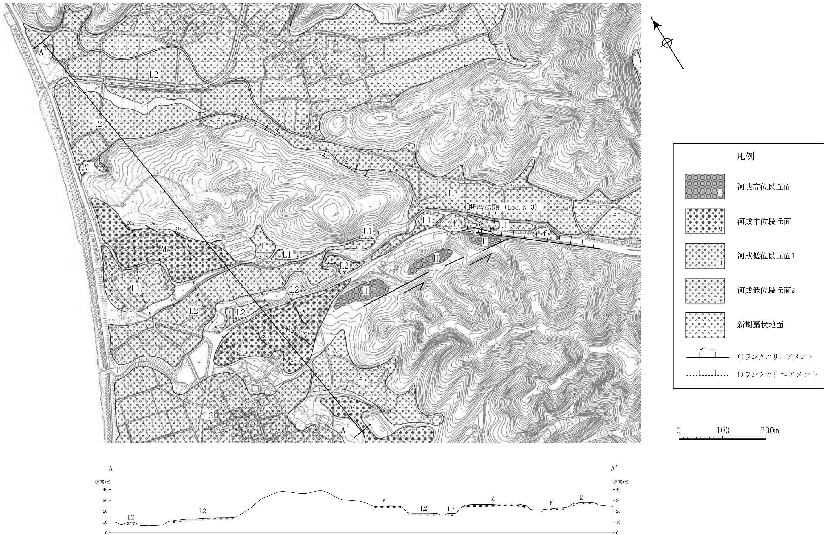
第7.4.2.153図 野坂断層 佐田付近の段丘面高度分布図 (Loc.N-1) 6-7-4-484
