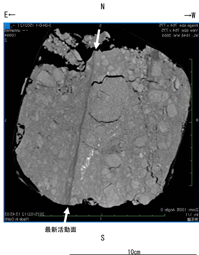
第7.4.4.21図 (1) D-1 破碎帯 電子顕微鏡観察結果 (2号炉原子炉建屋南側斜面) (その1)
