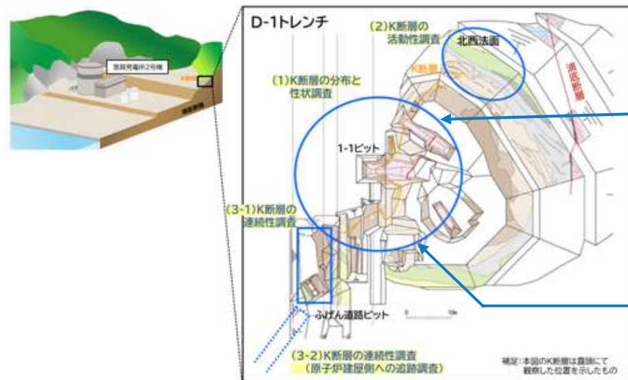
【K断層の分布と性状】D-1トレンチでのボーリング
