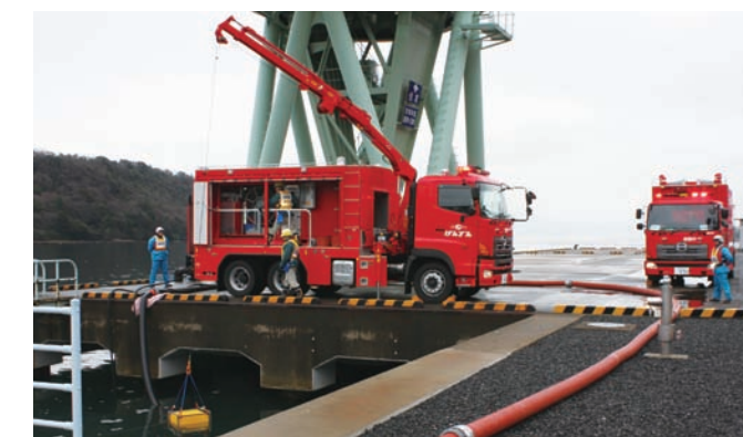
大容量ポンプ車の送水訓練
