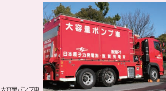
大容量ポンプ車
