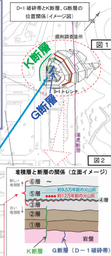
K断層の活動以降に積った地層 (この中の⑤層下部に約12万年前の火山灰が含まれている)
