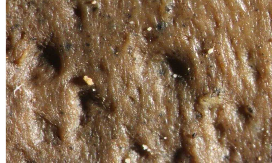
西側から東方を見る。西傾斜の断層面(A面)の下盤側表面の形態。高角度の条線,微小な窪みが認められる。
