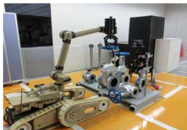
バルブの開閉操作
