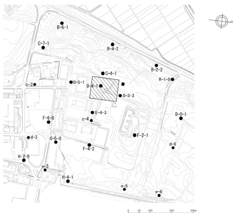
第 1.3.3-1 図 地下水位観測設備位置図 (再掲)
