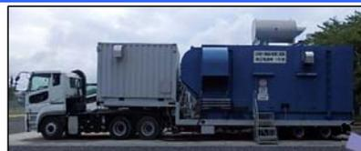
空冷式発電機からの電源供給
