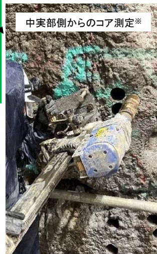
※コア抜きにより、コンクリート厚さを実測
