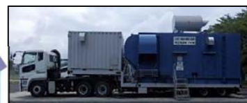
常設代替高圧電源装置 (空冷式発電機からの電源供給)
