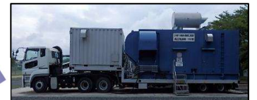
常設代替高圧電源装置 (空冷式発電機からの電気供給)
