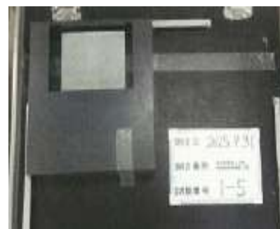
第18図 バックグラウンド補正係数設定のための試験時の試験体配置
