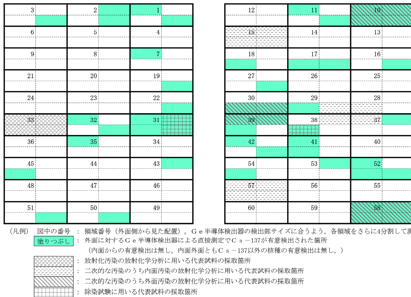
図ー 4 無作為に選定したアキュムレータ 1 体の内面汚染及び外面汚染をG e 半導体検出器で直接測定した結果並びに放射化学分析及び除染試験に用いた代表試料の採取箇所
