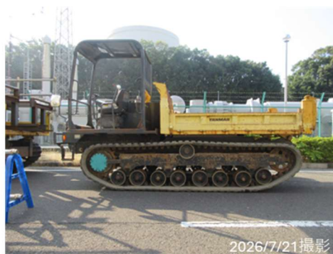
キャタピラ付き運搬車 (掘削用資機材の運搬用)
