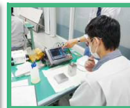
非破壊検査室での非破壊検査 (超音波による探傷検査)実習
